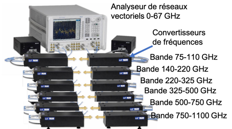
Figure 1. Problématique de la mesure large bande en gamme millimétrique et THz. Analyseur de réseaux vectoriel et extensions nécessaires (convertisseurs de fréquences) pour couvrir la bande 0-1 THz. Il faut 6 systèmes d'extension en plus de l'analyseur de réseau basse fréquence. Coût total (~1M€). Un seul convertisseur est utilisable à la fois entraînant de multiples opérations manuelles et procédures de calibration. (Adaptée de vadiodes.com)
