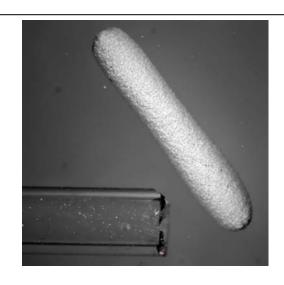
Figure 1 : Bulle en armure formée par injection de liquide dans un capillaire recouvert de grain.
