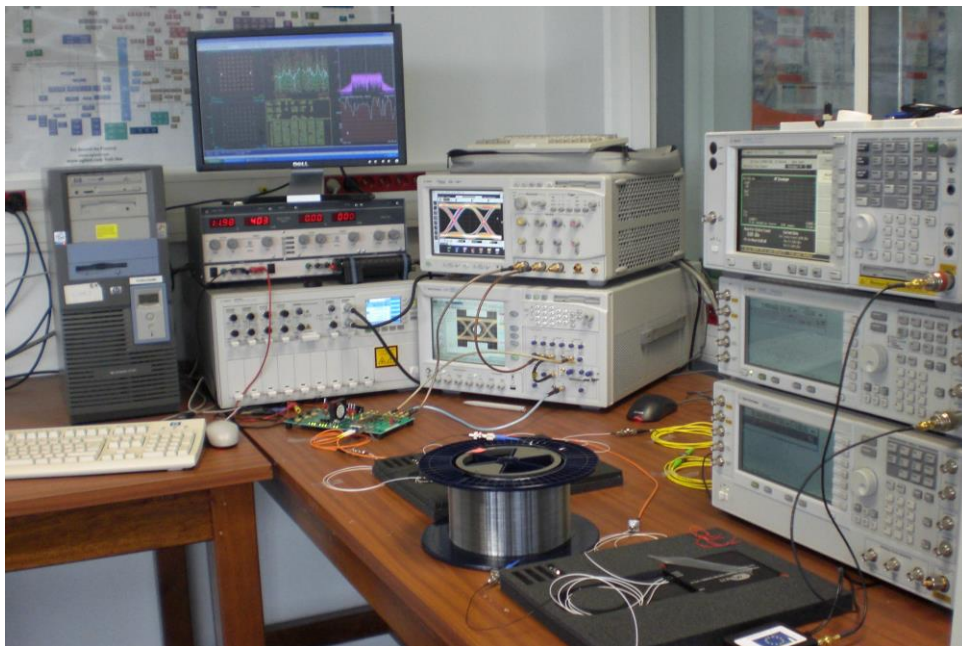
Figure 5 - Banc de test de transmission optique de signaux LTE et WiMedia sur fibres multimodes de verre à des longueurs d'onde de 850 nm.
